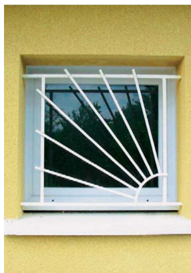
SOLEIL 750 x 600 mm Traverses tubulaires de 16 x 16 mm Montants et rayons en fer carré plein de 12 mm. Finition pré-peint. Réf. 1591373
