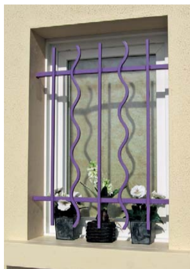
LAZURE 750 x 600 mm Traverses tubulaires de 20 x 20 mm Barreaudage droit et ondulé en fer plein de 12 x 12 mm. Finition pré-peint. Réf. 1367166
