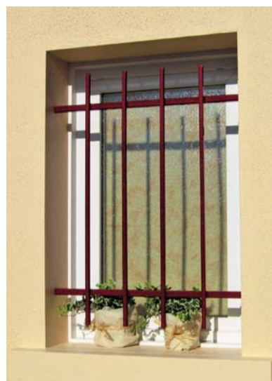
MISTRAL 750 x 600 mm Traverses tubulaires de 20 x 20 mm Barreaudage en fer carré plein de 12 x 12 mm. Finition pré-peint. Réf. 3247983
