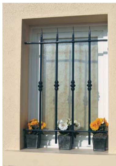
NANCY 750 x 600 mm Traverses en fer plein de 30 x 8 mm Barreaudage forgé en fer rond plein de 14 mm avec pointes en partie haute. Finition pré-peint. Réf. 1779065
