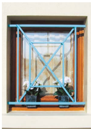
MARGAUX «S» 750 x 600 mm Traverses tubulaires de 20 x 20 mm Montants et diagonales en fer plein. Finition pré-peint. Réf. 1413061
